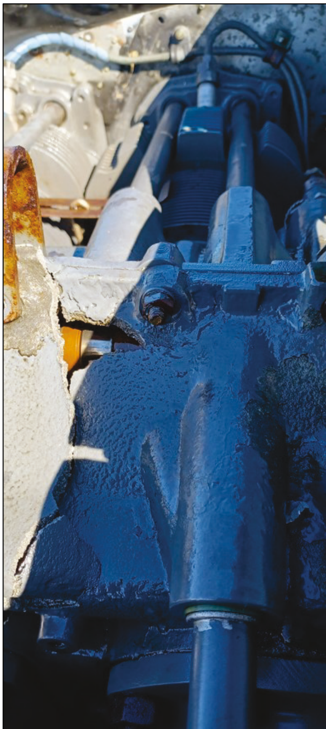
Foto 1. Revner og hul i motorblokken
