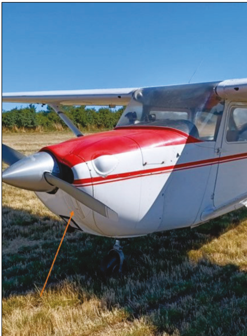
Figur 2. Olie-lækage under propel umiddelbart efter nødlandingen
